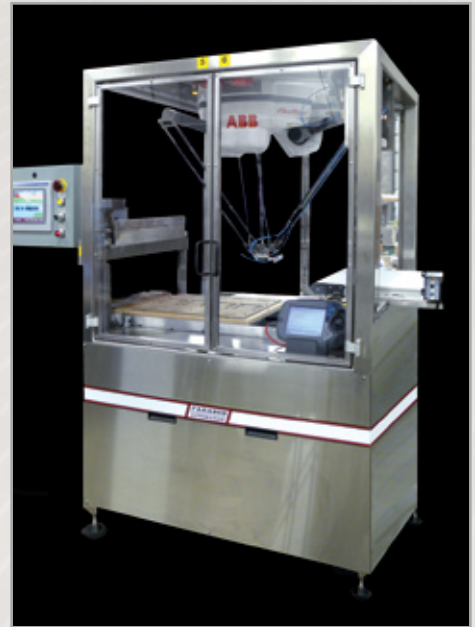
ABB IRB360 FlexPicker unloader
